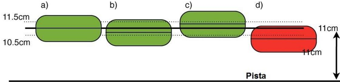
Independientemente de la forma que tenga del tubo utilizado para la barra (redonda o rectangular), la medida de 11 cm debe ser tomada desde el centro de la barra como se muestra arriba.
